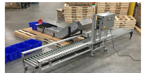
Système de remplissage de boîtes en ligne de base et abordable avec intégration du système DynaCon®.
