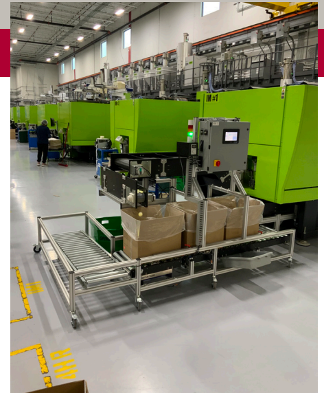
La configuration en ligne comprend une balance pour les poids et prend en charge une stratégie de fabrication d'extinction des lumières.
