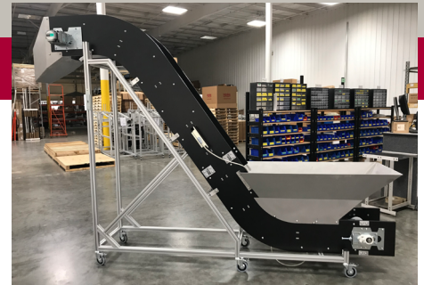
Trémie en acier inoxydable de grande capacité qui comprend un système intégré de détection de métaux.
