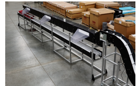
Solution de convoyeur multi-piles avec trois stations de tri/diffusion.
