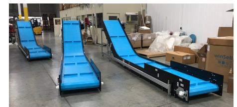
Courroie à fort impact avec parois latérales continues et résistance à l'abrasion.
